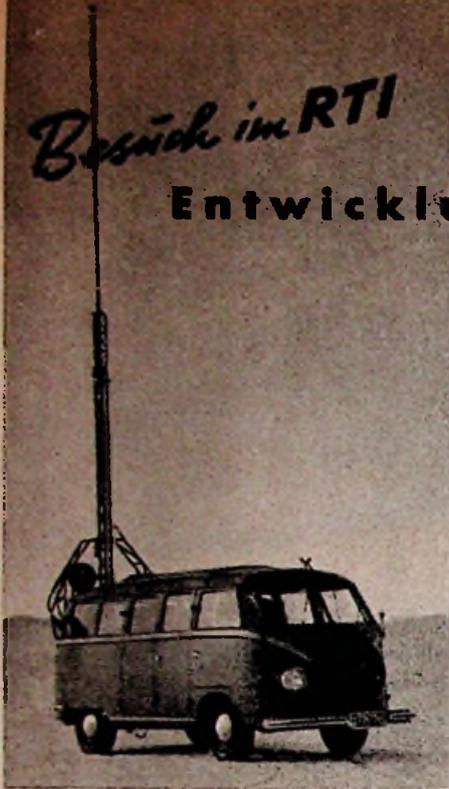
Feldstärke-Meßwagen des RTI mit Antennenmast
